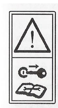
Fig. 2. Slå av motoren og ta ut nøkkelen før du starter service eller reparasjoner (plassert på plogstangen).
